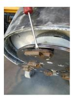
**3)** Haga palanca cuidadosamente con el fin de sacar el segmento de diamante. Ya lo podrá sustituir.**x**
