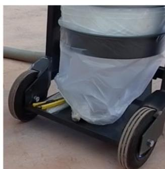
Vaciar los desechos presentes al interior del saco en un contenedor destinado a la eliminación de los residuos según las leyes vigentes en el país de utilización del aspirador.
